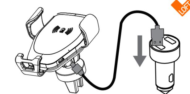
Conecte o cabo micro USB no carregador sem fio.
