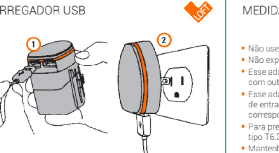
Conecte o carregador USB ao adaptador. Plugue o dispositivo através do cabo USB na porta USB (1). O carregador USB pode ser usado em sistemas elétricos ao redor do mundo, com uma voltagem de entrada de 100-240 Volts.
